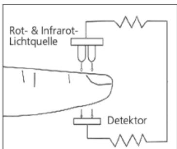
Abbildung 1: Messprinzip
