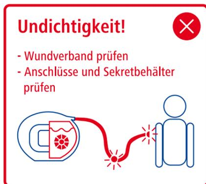
Diese Fehlermeldung wird hervorgerufen bei Undichtigkeiten im System, die nicht durch die Unterdruckeinheit kompensiert werden können.
