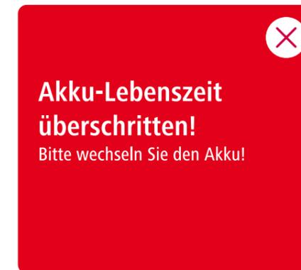
Diese Warnmeldung kann durch das Berühren der ✖ Taste geschlossen werden und erscheint erst wieder bei einem Neustart der Unterdruckeinheit.
